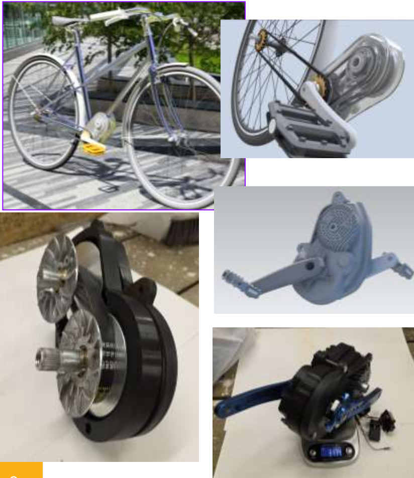
Трансмиссия для велосипеда на основе вариатора (ООО «Амур механика»)
