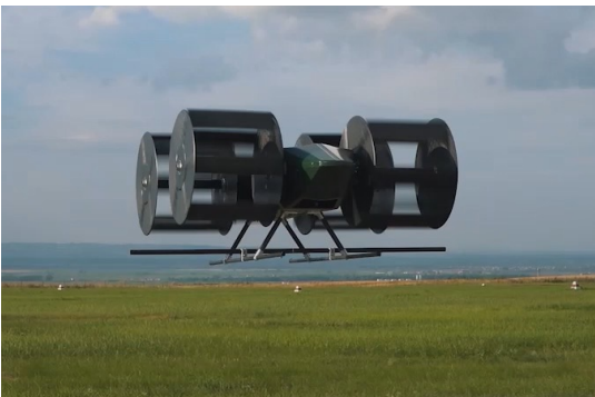
Циклодрон Габаритный размер ротора 500 мм Тяга 4 роторов 65 кг
