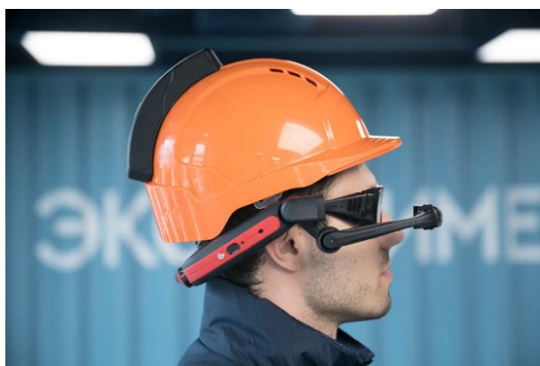
Интернет вещей в логистике (сотрудник нефтяной компании тестирует каску, отслеживающую местоположение и состояние здоровья человека [2])
